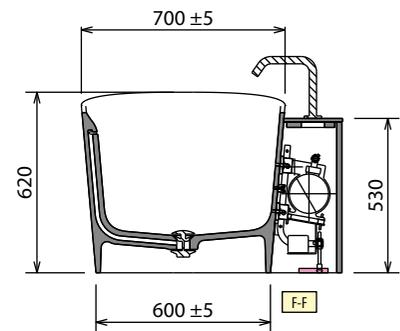
\* Bereich für die Vorbereitung des elektrischen Anschlusses für Wannen mit Rundum-Beleuchtung. Planen Sie eine Fernbedienung zum Ein- und Ausschalten (ist nicht im Lieferumfang enthalten).
